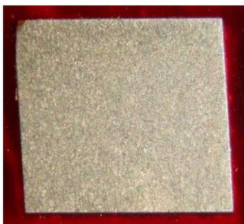
Gambar 10. Struktur Mikro Sampel dengan *Quench Oli* dengan Perbesaran 10x
